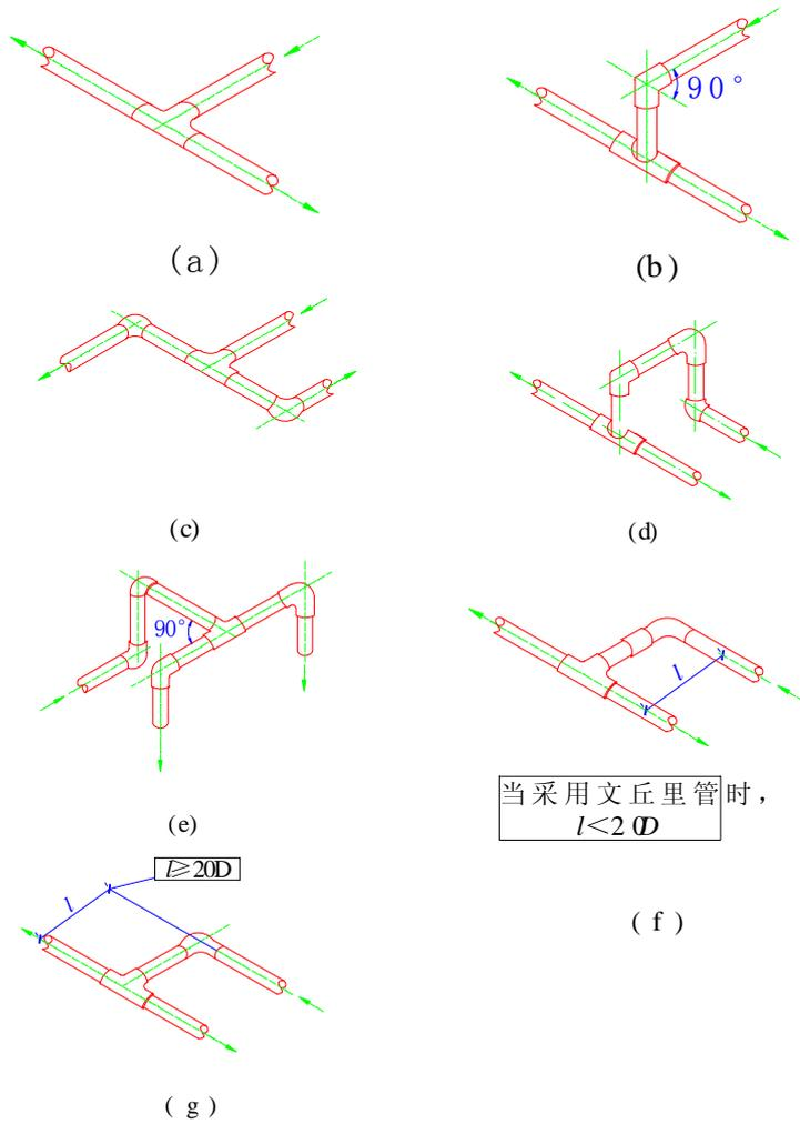
图 B 管网分支结构图
